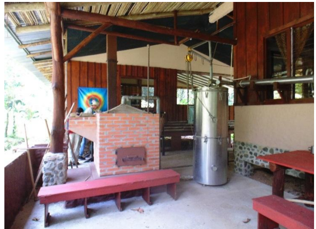
Fotografía 34. En esta imagen se muestra la hornilla de leña para alimentar la caldera de vapor de agua, y destiladora utilizada para la elaboración de los aceites esenciales.
